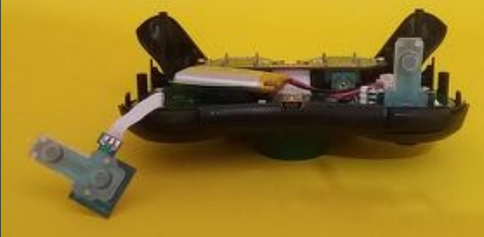
**Colocamos la placa electrónica a un lado del control, en una posición que le resulte cómoda para empezar a soldar.**
