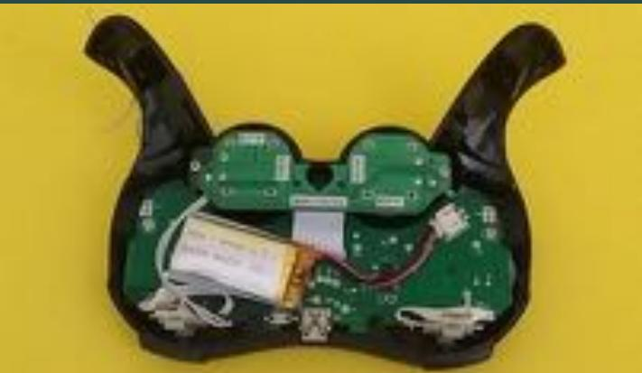
**Volvemos a colocar la placa del joystick, acomodando los cables**
