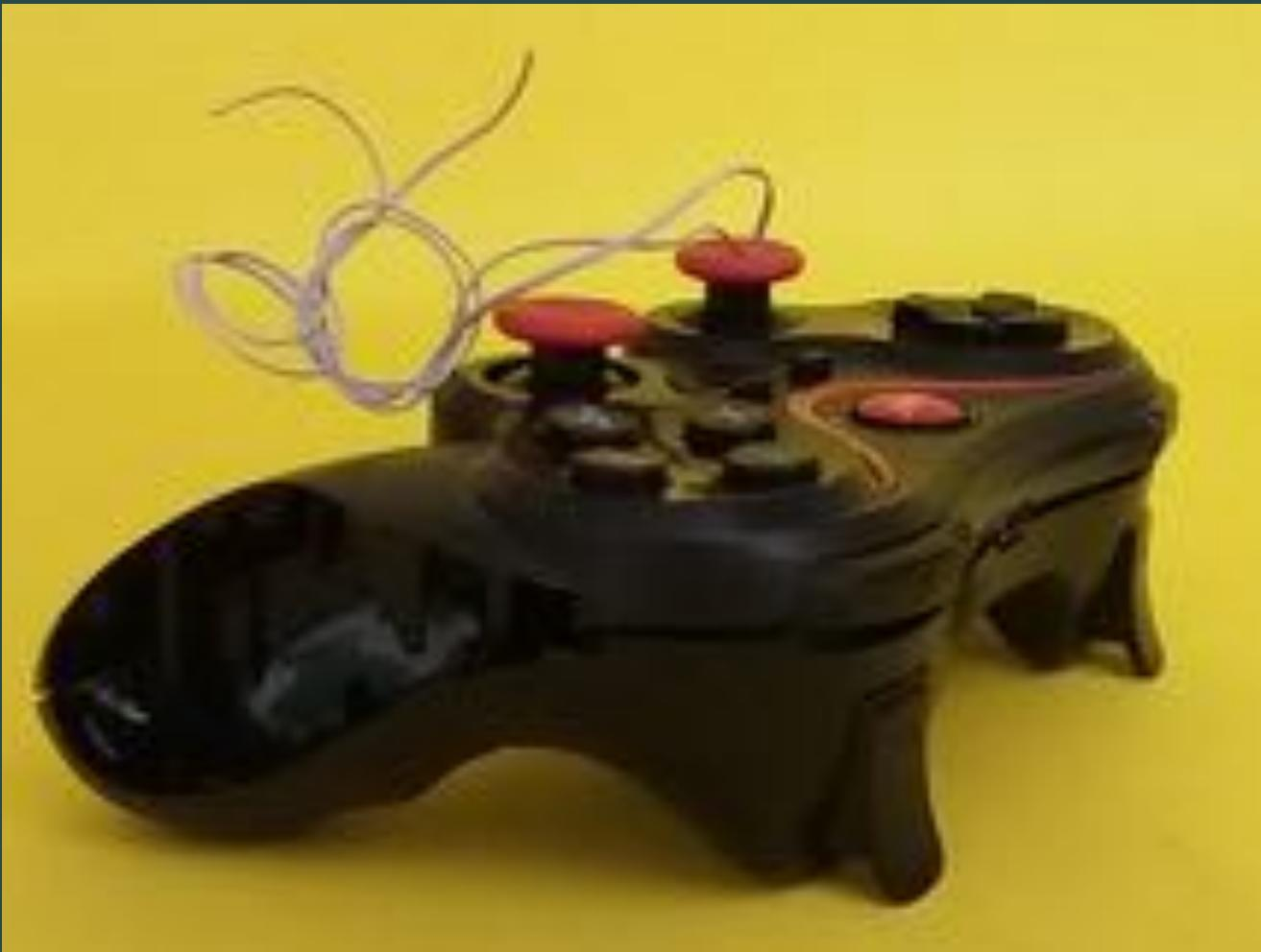
**Volvemos a colocar los tornillos al control del videojuego, dejando fuera dos tornillos, preferiblemente los de los laterales.**
