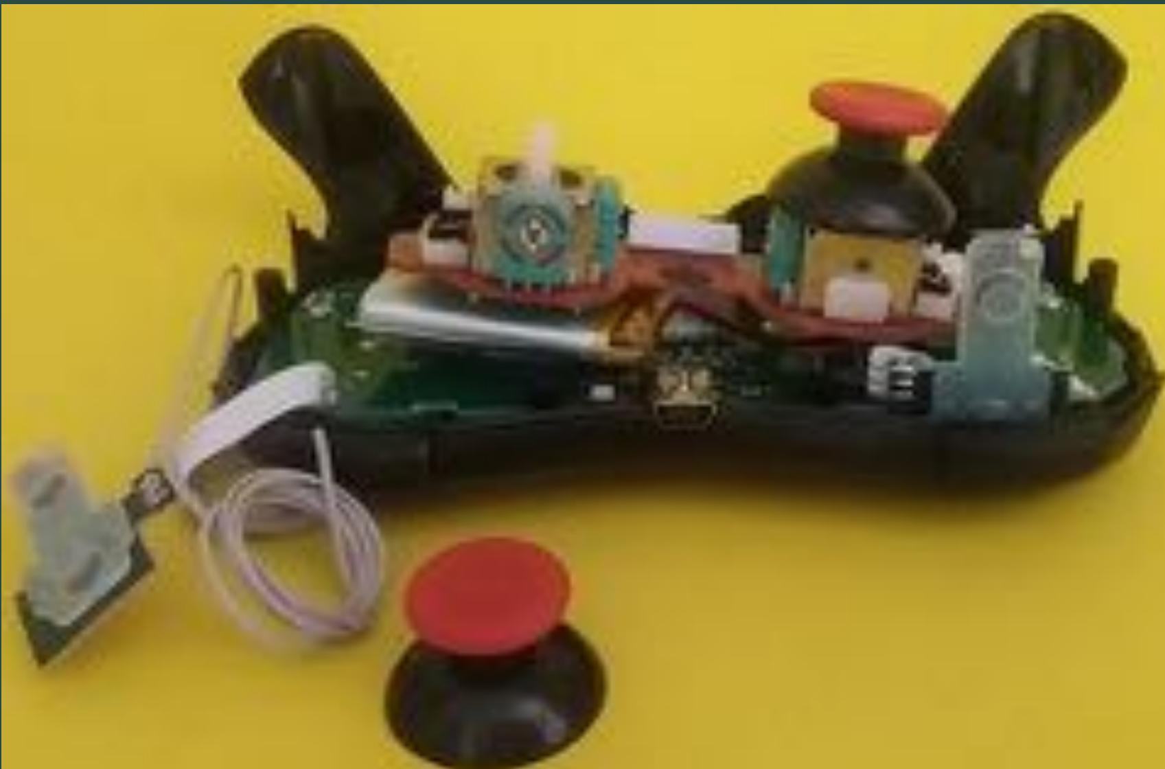
**Colocamos el Thumbstick boca abajo y localizamos visualmente los 4 compartimentos laterales.**
